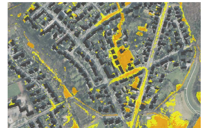
Abb. 27 Darstellung der maximalen Wasserstände aus der Überflutungssimulation (gelb: > 0,10 m, orange > 0,25 m; Hintergrund: Orthofoto)
